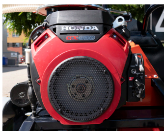
Zeer betrouwbare 21 pk/15,5 kW GX630 Honda V-twin benzinemotor.
