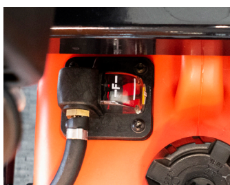
Brandstoftank met brandstofmeter.
