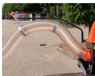
Zuigslang met een bereik van 5 m wordt ondersteund door een zwenkbare draagarm.
