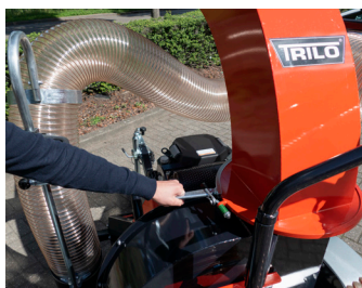
Het uitblaaskanaal kan 360 graden gedraaid worden.
