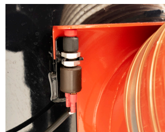
Veiligheidssensor op het waaierhuis schakelt de motor uit bij onderhoudswerk.
