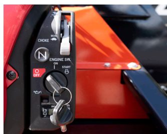
Handig geplaatste bedieningspaneel en voorzien van een elektrische startmotor.
