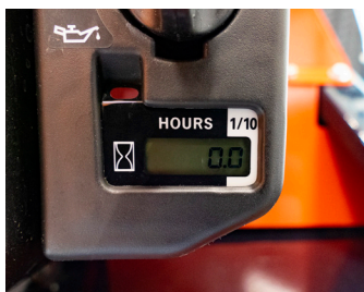
Uitgerust met een oliepeil waarschuwingslampje en een urenteller.
