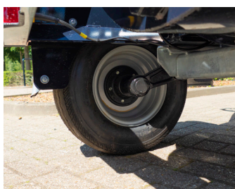
Gegalvaniseerde as met torsievering, geschikt voor transport op de openbare weg (bij 80 km/u).
