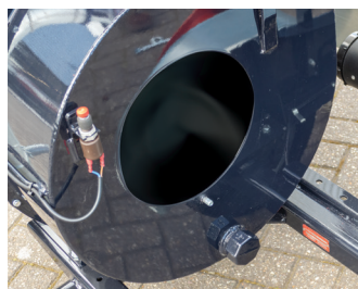
Waaier en slijtplaten makkelijk toegankelijk voor onderhoud.
